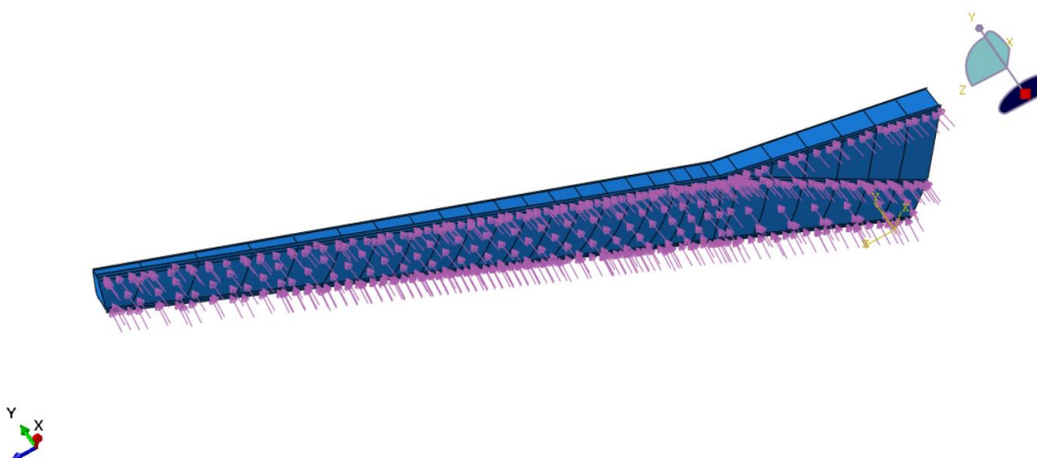
Slika 15. Tlačno opterećenje sile uzgona
