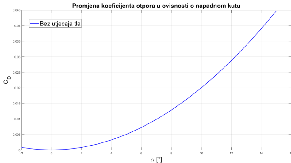
Slika 4 Promjena koeficijenta otpora C_D u ovisnosti o napadnom kutu \alpha bez utjecaja tla
