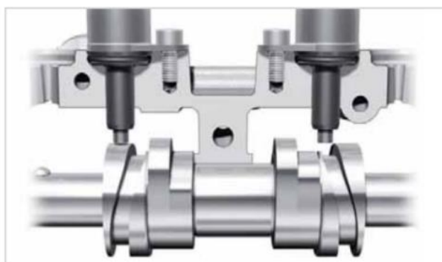
Slika 6. Sustav s pomičnim brijegom bregastog vratila [4]
