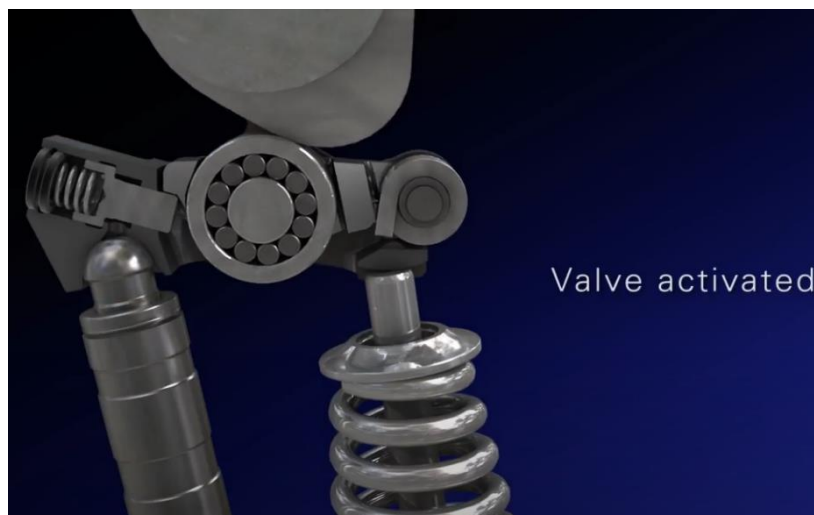
Slika 4. Sustav pomičnih poluklackalica s dva bregasta vratila za slučaj uključenih cilindara [3]
