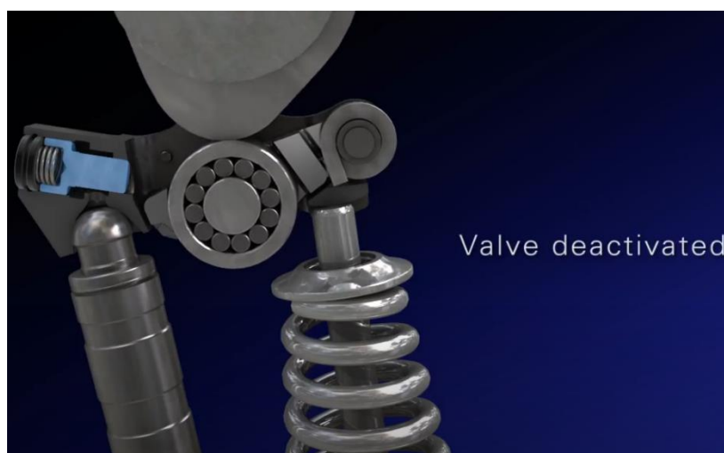
Slika 5. Sustav pomičnih poluklackalica s dva bregasta vratila za slučaj isključenih cilindara [3]
