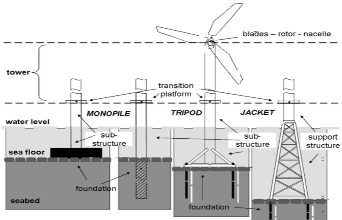
Slika 7. Glavni dijelovi vjetroelektrane na moru [3]
