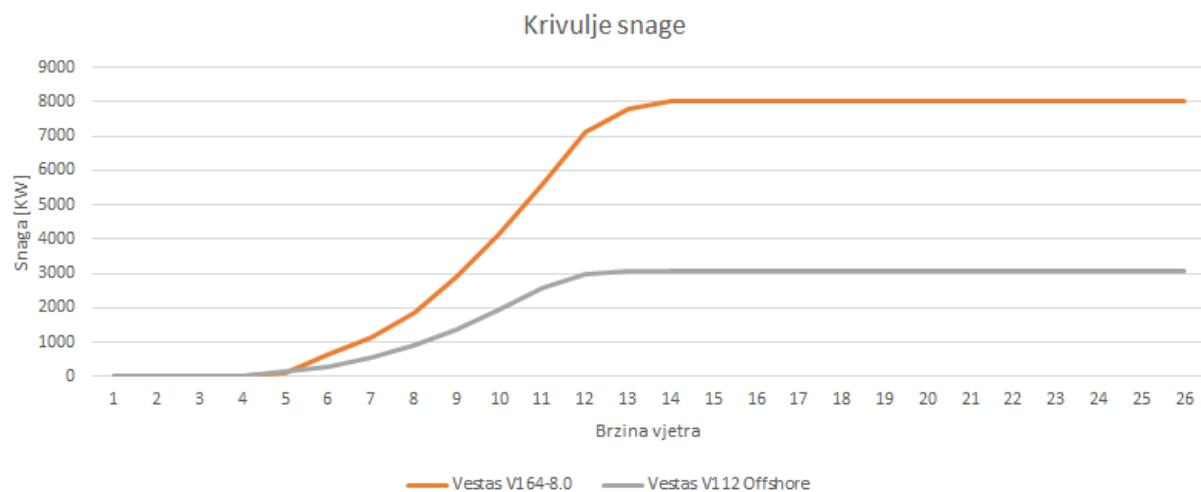
Slika 26. Graf krivulja snage dviju uspoređivanih turbina
