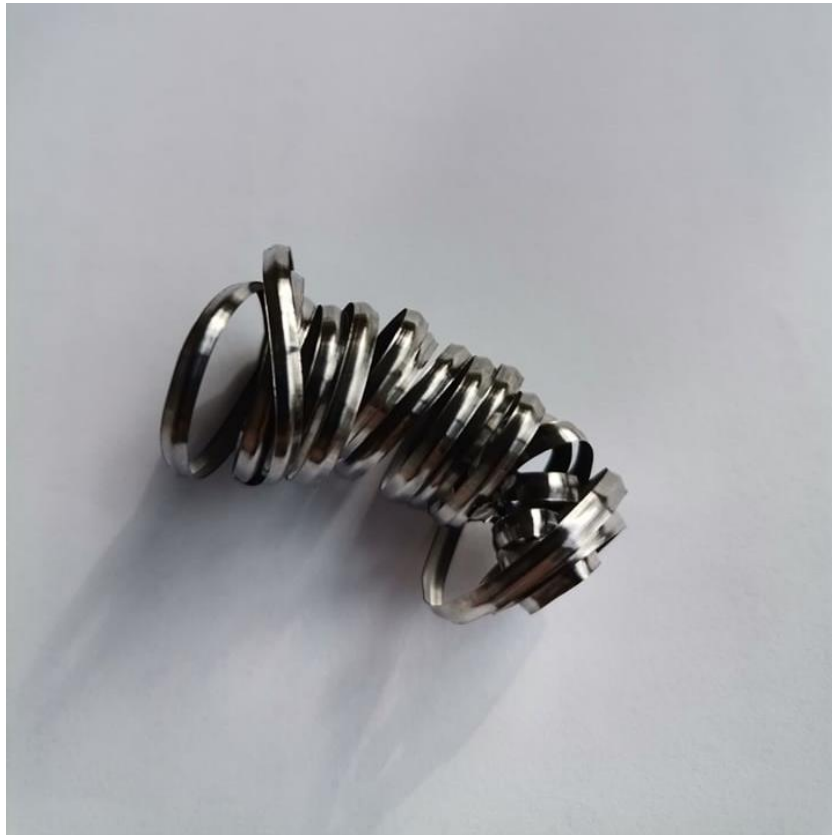
Slika 8. Kontinuirano odvojena čestica konvencionalno proizvedene Ti6Al4V legure
