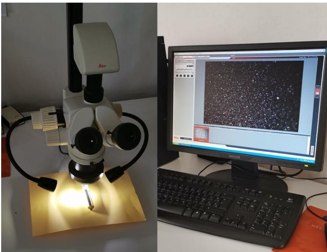
Slika 19. Stereomikroskop Leica MZ6 i računalo s programom za obradu slike s mikroskopa
