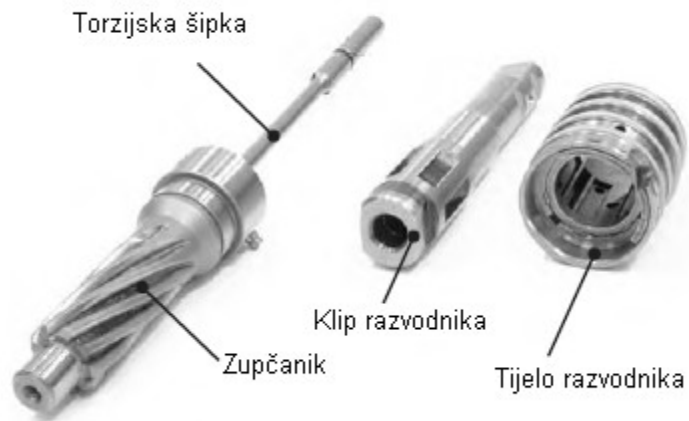
Slika 5. Slika prikazuje razvodnik kad je rastavljen.
