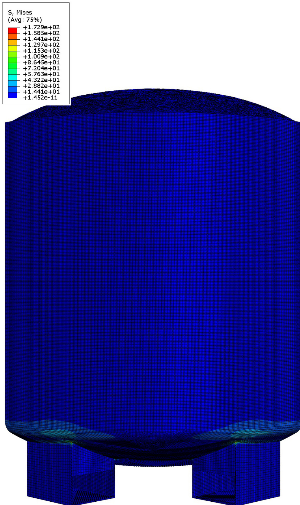
Slika 49. Naprežanje spremnika prema von Misesu
