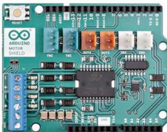
Slika 28. Arduino motor shield [16]
