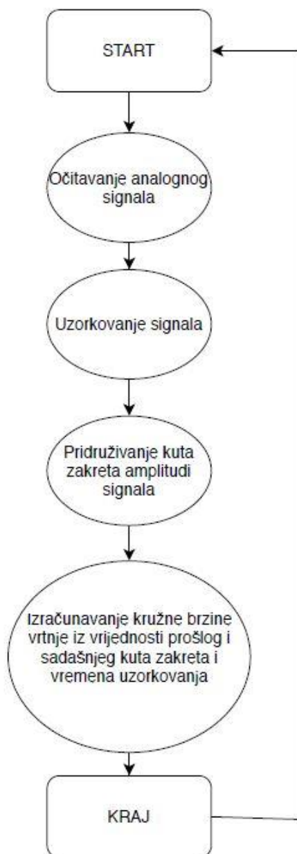
Slika 32. Algoritam za mjerenje brzine vrtnje vratila elektromotora
