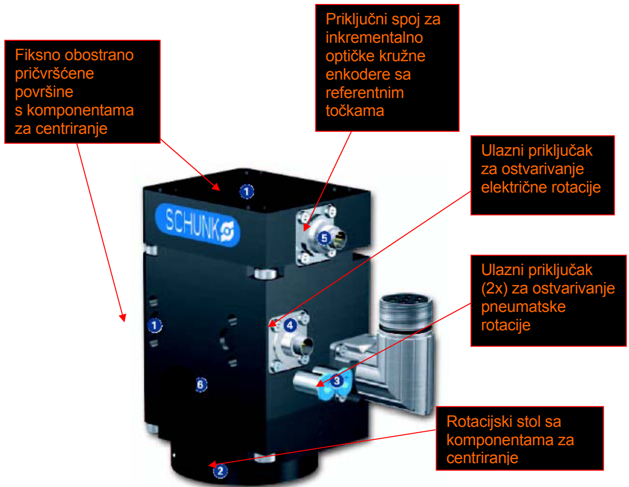
Slika 43. Komponente Torque motora Lirax – M RD [16]
