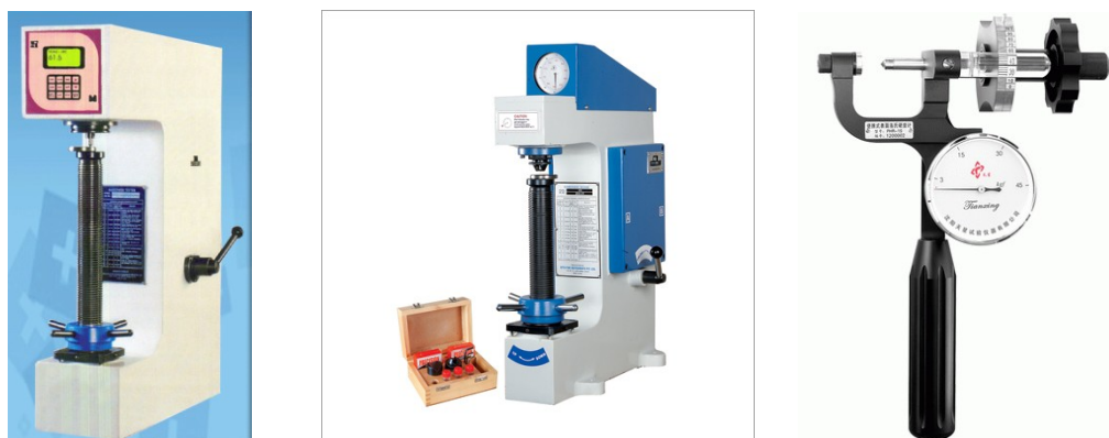
Slika 8. Uređaji za mjerenje tvrdoće po Rockwellu [10] i [11]
