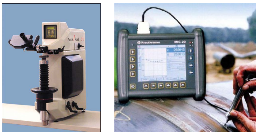
Slika 5. Uređaji za mjerenje tvrdoće po Vickersu [2]
