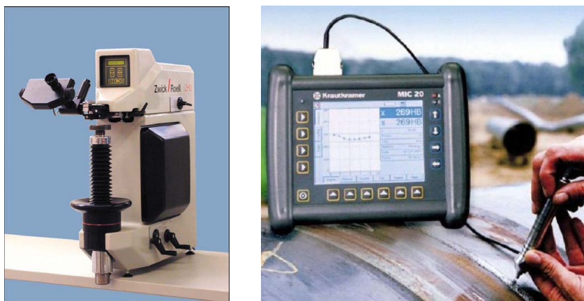
Slika 5. Uređaji za mjerenje tvrdoće po Vickersu [2]
