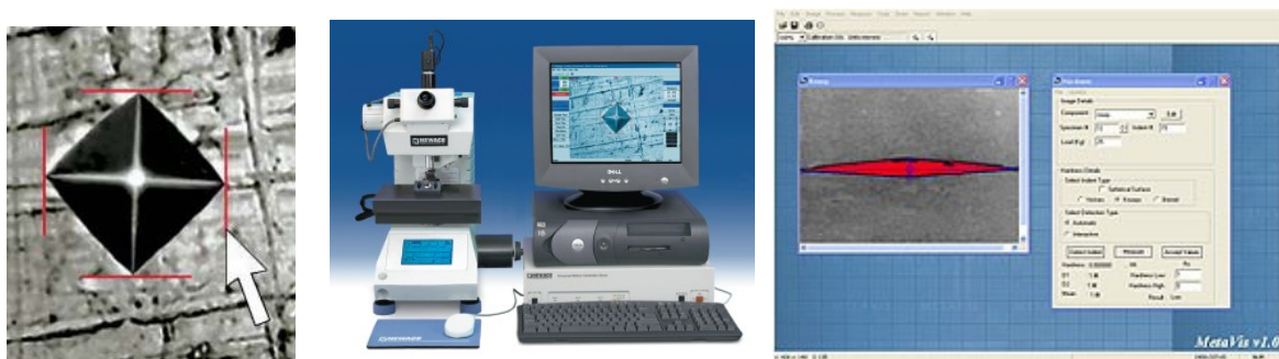
Slika 12. Mjerenje dijagonale otiska uz pomoć računala [16]
