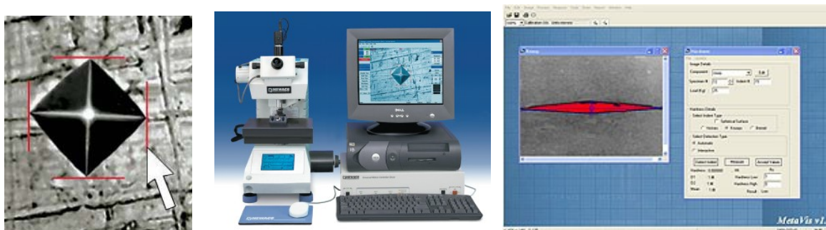
Slika 12. Mjerenje dijagonale otiska uz pomoć računala [16]
