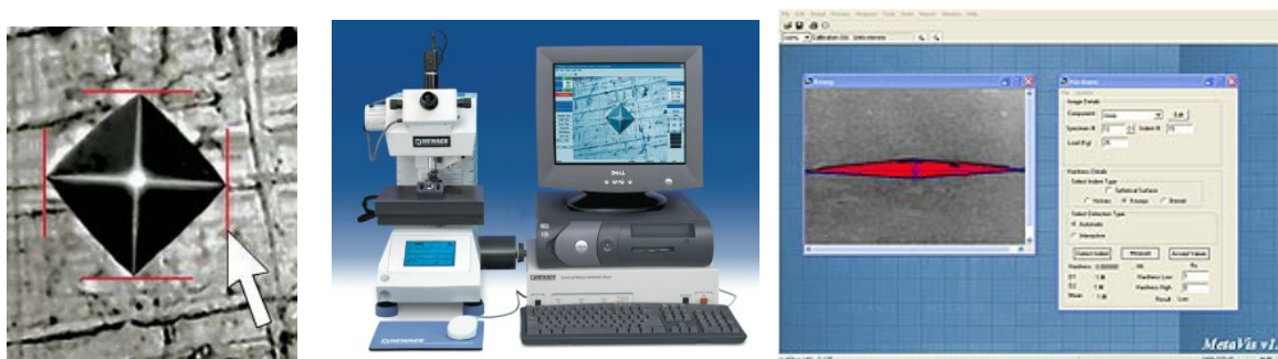
Slika 12. Mjerenje dijagonale otiska uz pomoć računala [16]
