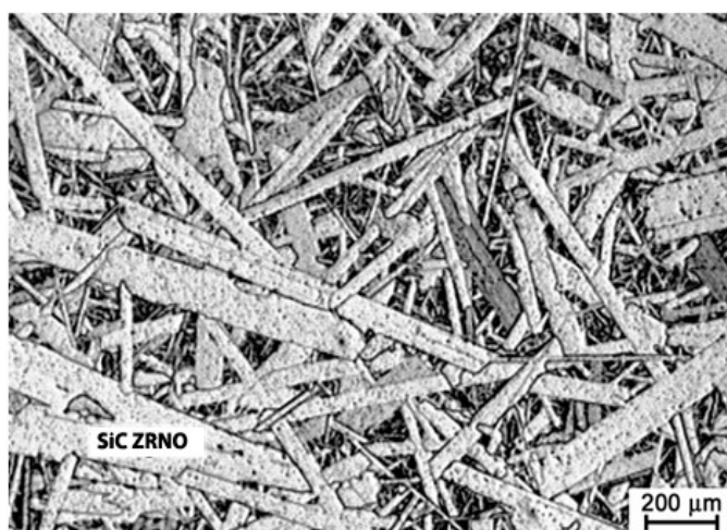
Slika 26. Mikrostruktura grubozrnatog silicijeva karbida sinteriranog bez tlaka
