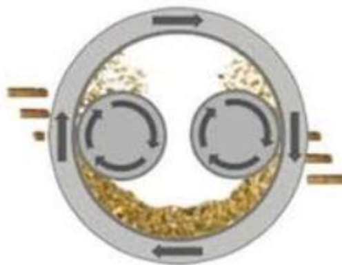
Slika 11. Azeus SZLH - prstenasta matrica i valjci za protiskivanje
