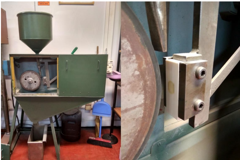
Slika 26 Slika uređaja "suhi pijesak/gumeni kotač" i uzorka u držaču
