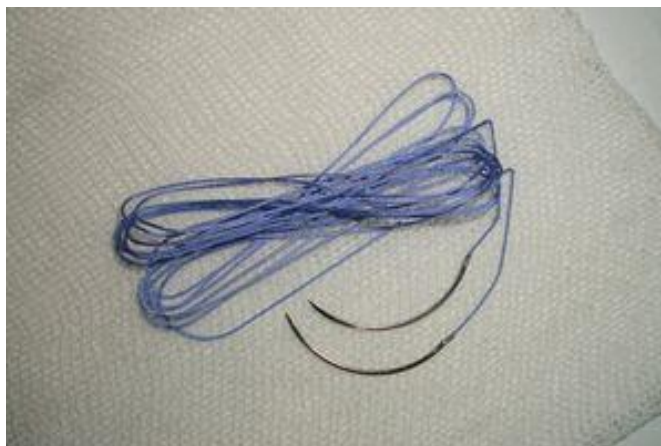
Slika 3 Kirurški konac napravljen od PLA kompozita [6]
