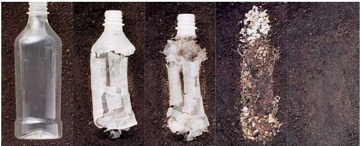
Slika 6 Razgradnja boce od PLA u 80 dana [8]
