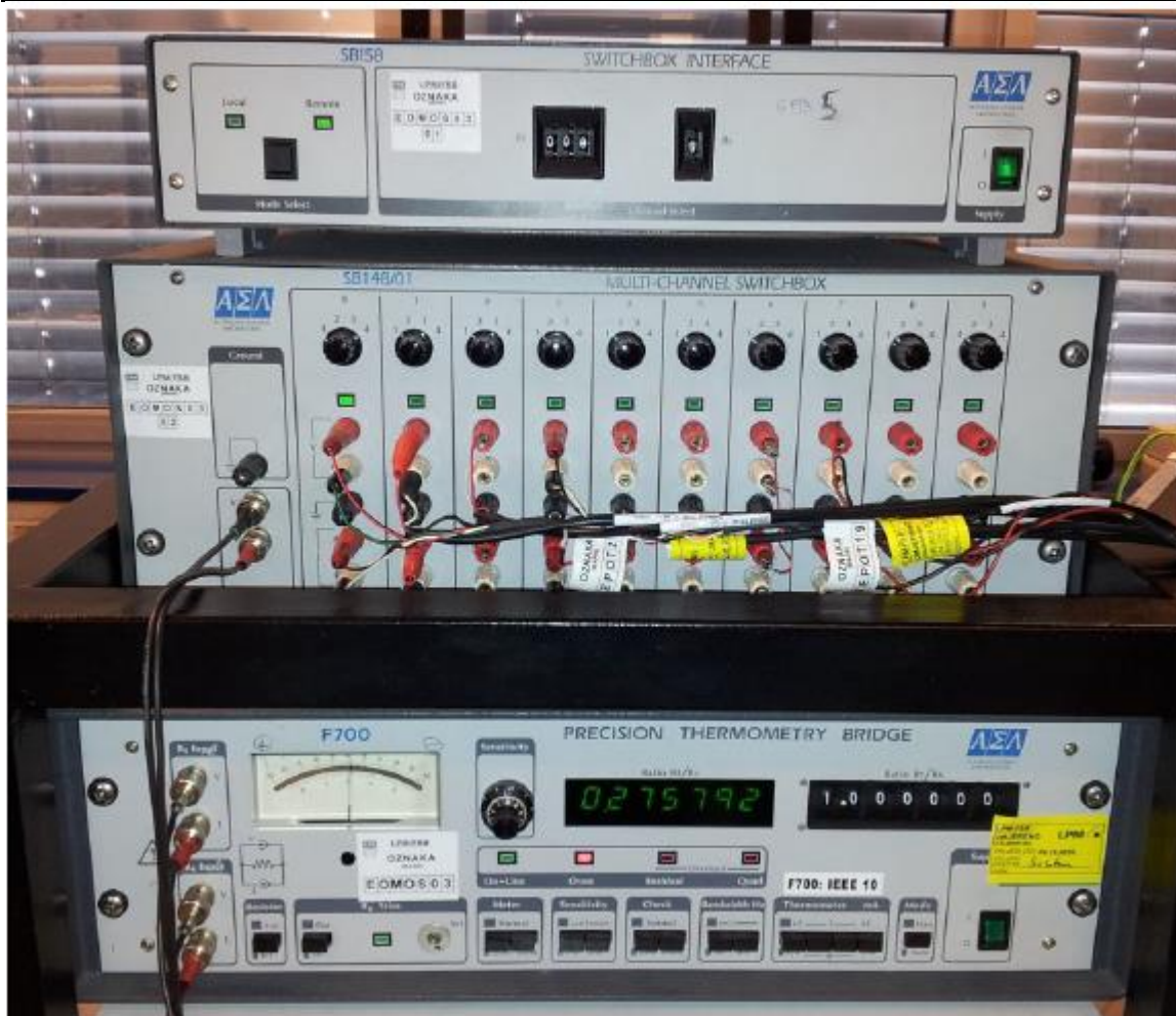
Slika 10. Termometrijski otpornički most F700
