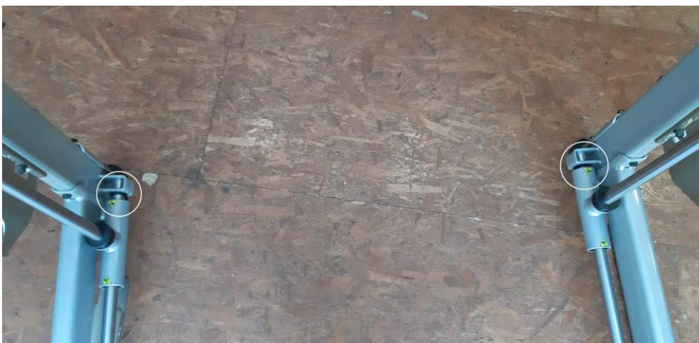
Slika 6.7. Razlog mogućeg zakretanja šipke u horizontalnoj ravnini
