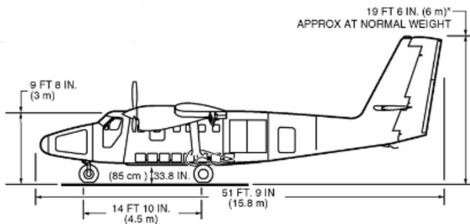
Slika 8. Bokocrt zrakoplova DHC-6 Twin Otter serije 300 [14]
