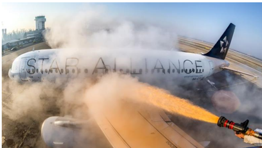
Slika 4. Odleđivanje zrakoplova na zemlji 3
