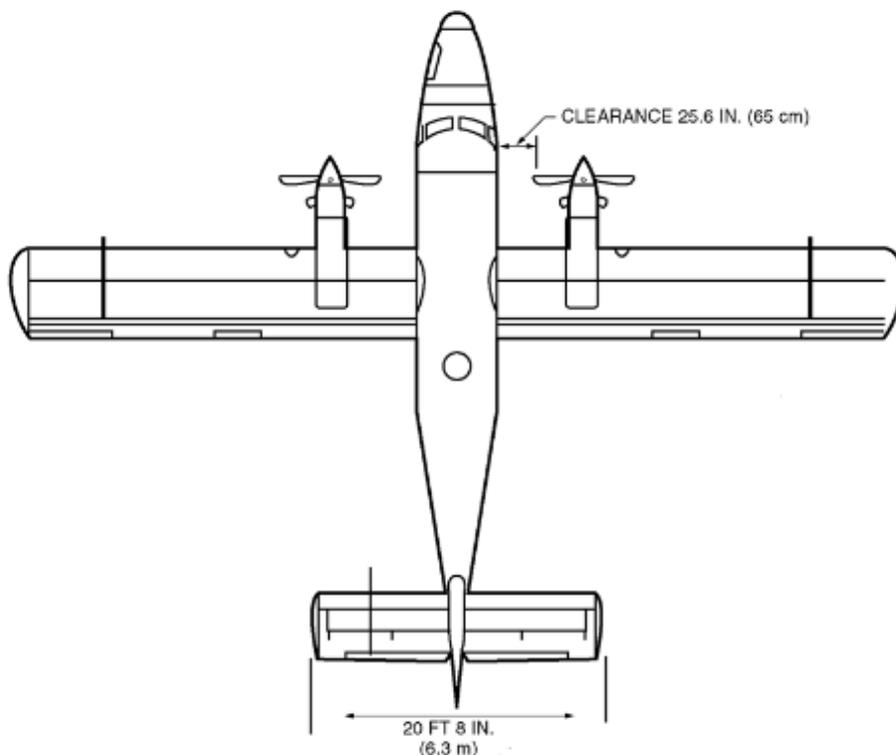
Slika 7. Tlocrt zrakoplova DHC-6 Twin Otter serije 300 [14]
