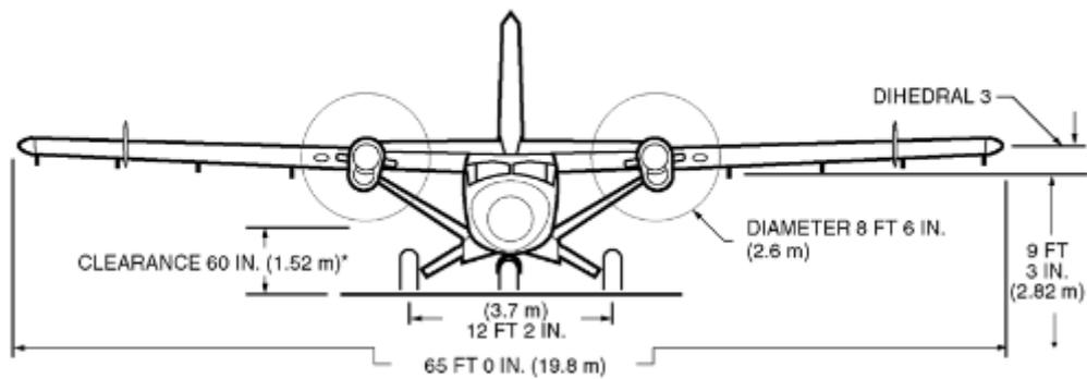
Slika 6. Nacrt zrakoplova DHC-6 Twin Otter serije 300 [14]
