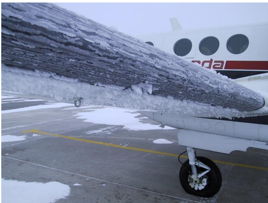
Slika 1. Nakupine leda na napadnom rubu krila 1
