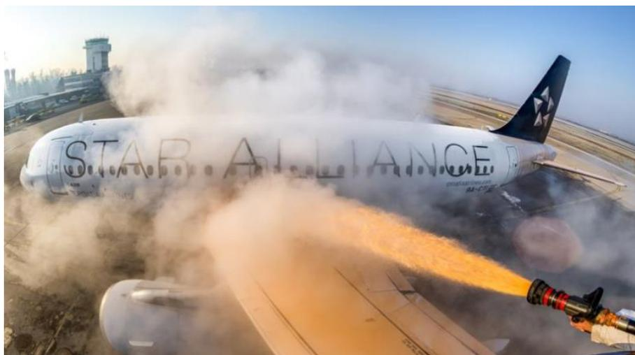
**Slika 4. Odleđivanje zrakoplova na zemlji<sup>3</sup>**
