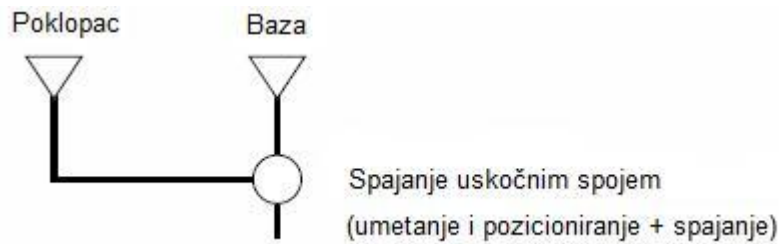
Slika 6. Istovremeno odvijanje operacija montaže
