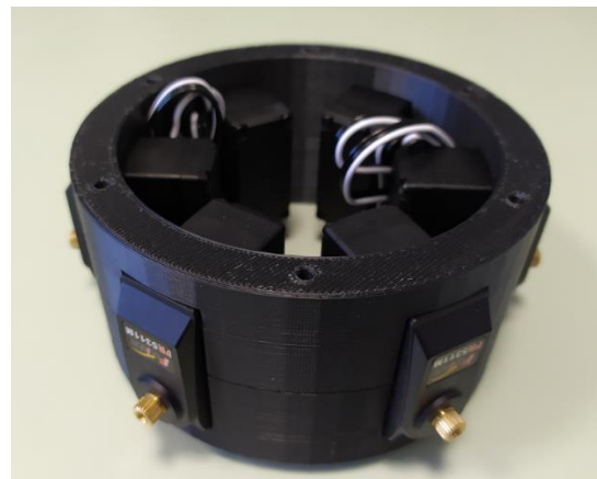
Slika 6.25: Modul za aktivno upravljanje nagibom krakova rotora.
