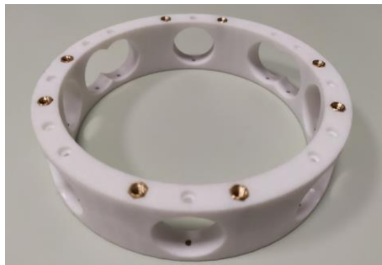
Slika 6.16: Unutarnji prsten s pričvrstnim elementima.
