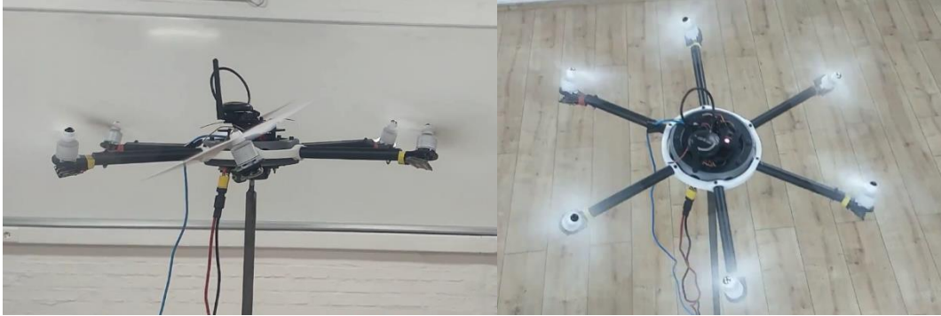
Slika 6.10: Testiranje potpuno upravljane konfiguracije sa 6 rotora.
