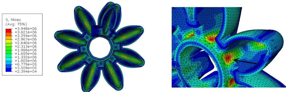
Slika 3.4: Simulacija za Prototip II. i detalj raspodjele naprezanja sa strelicom koja pokazuje točku maksimalnog naprezanja.
