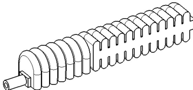
Slika 3.9: Pneumatski aktuator desnog palca - izometrijski pogled
