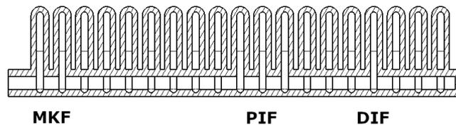
Slika 3.7: Pneumatski aktuator prsta - poprečni presjek
