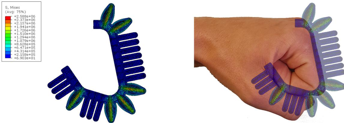
Slika 3.8: Simulacija modela prsta pri tlaku od 0.52 bar
