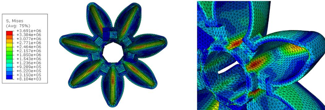
Slika 3.6: Simulacija za Prototip II s udubinom na donjoj stijenci. Slika desno prikazuje detalj raspodjele naprezanja .
