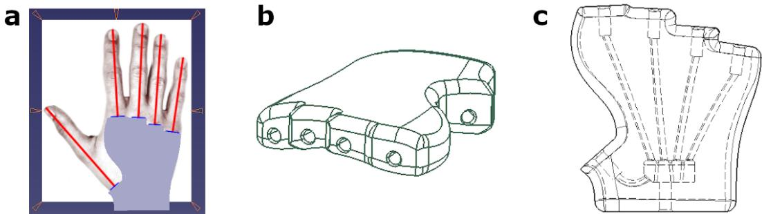
Slika 3.11: Modeliranje dlana u programskom paketu CATIA: a) korištenje slike kao referenca za precizno modeliranje geometrije, b) izometrijski prikaz krajnjeg oblika dlana, c) tlocrt dlana sa prikazanim sustavom kanalića koji dovode zrak do pneumatskih aktuatora
