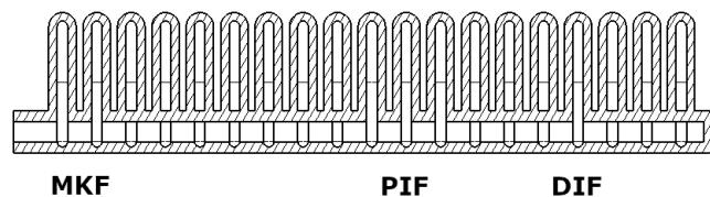
Slika 3.7: Pneumatski aktuator prsta - poprečni presjek
