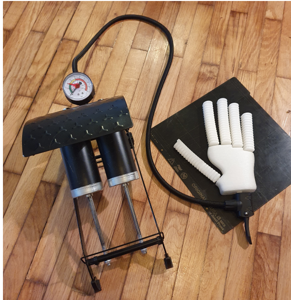
Slika 4.3: Eksperimentalni postav - nožna pumpa i šaka od pneumatskih mreža
