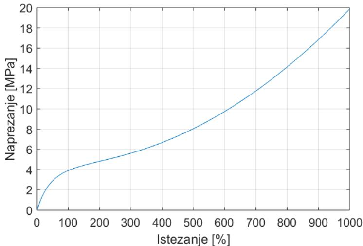
Slika 3.1: Krivulja naprezanja i istezanja za materijal NinjaFlex
