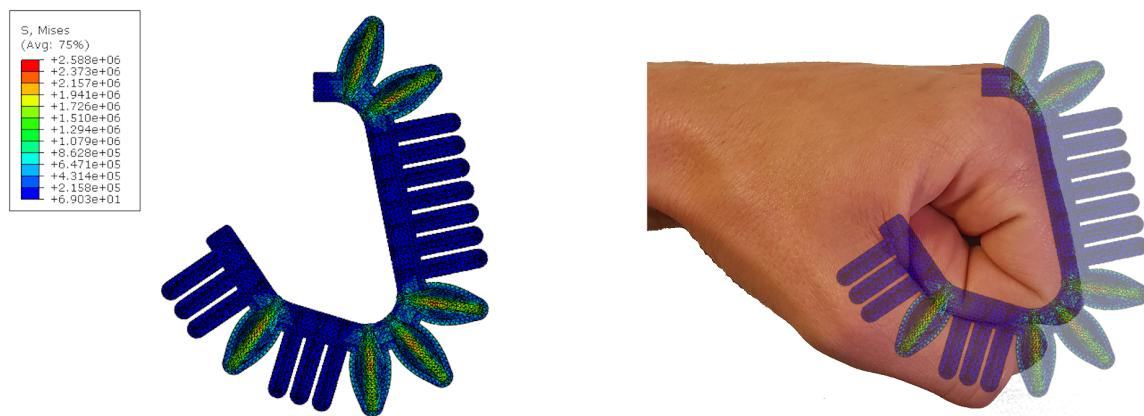
Slika 3.8: Simulacija modela prsta pri tlaku od 0.52 bar
