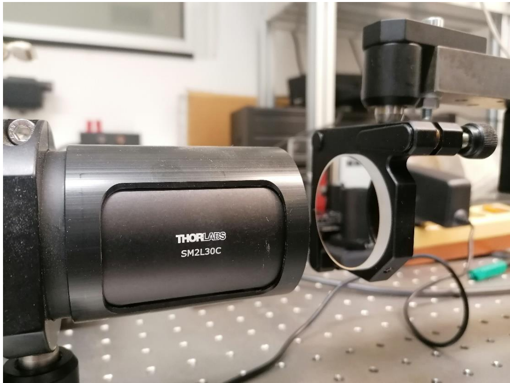
Slika 4. Zrcalo digitalnog autokolimatora
