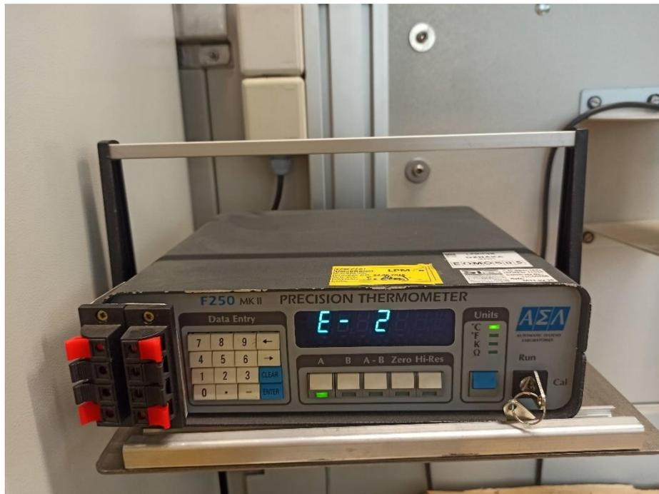
**Slika 15. Precizni indikator temperature**
