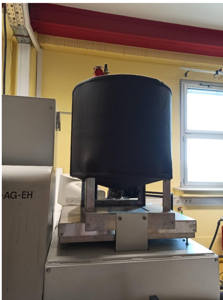
Slika 14. Platforma s vagom
