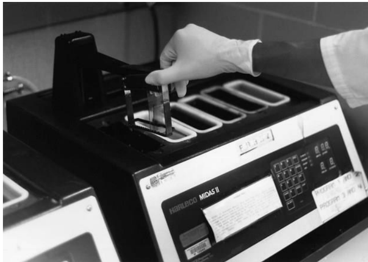
Slika 17. Uređaj za izradu razmaza Midas II [7]
