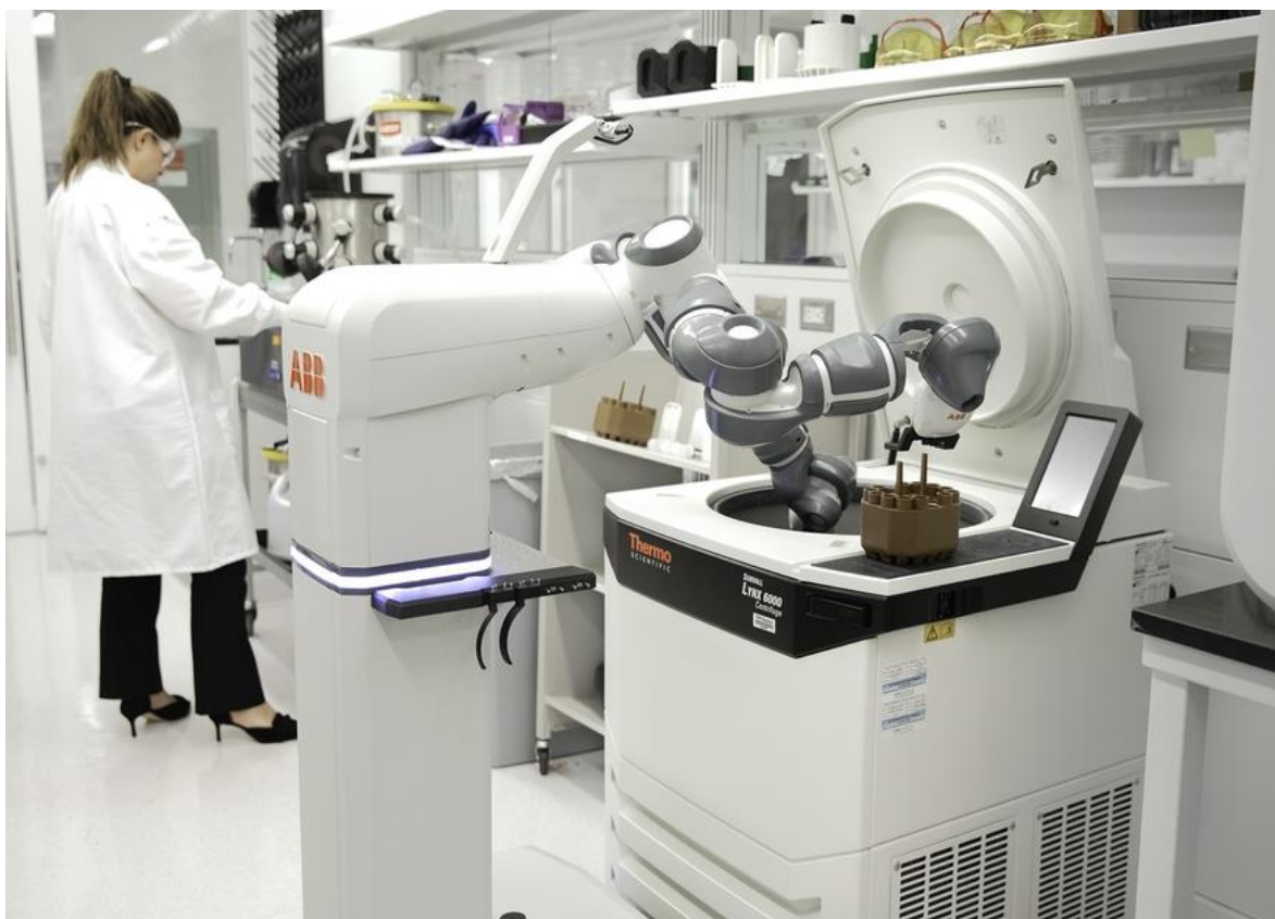
Slika 8. Robot ABB Yumi za asistenciju u laboratorijima [9]
