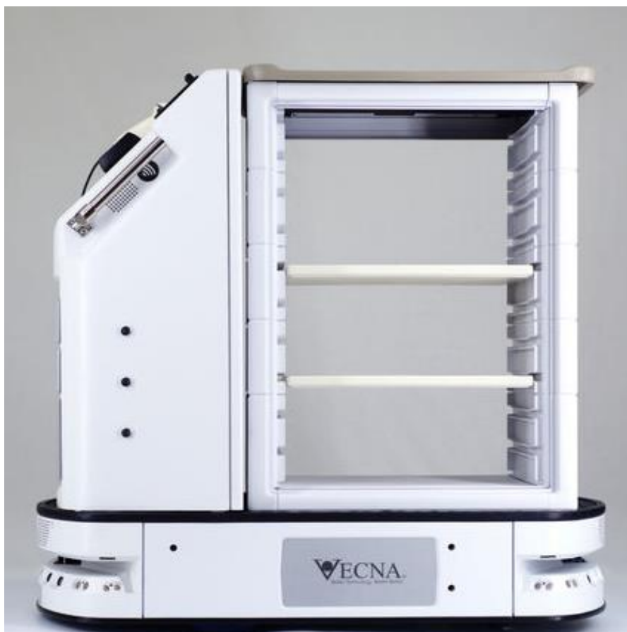
Slika 2. Mobilni laboratorijski robot QC Bot [22]
