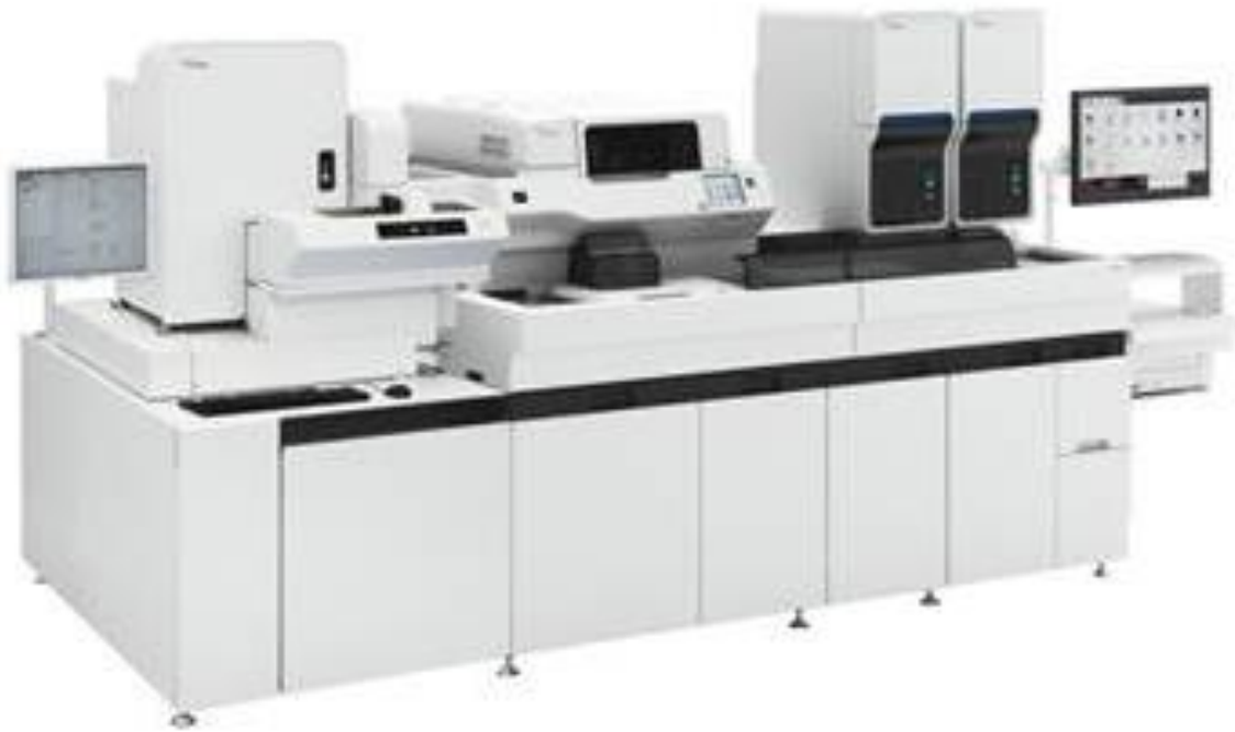
Slika 19. Integrirani automatski uređaj za razmaz krvi Sysmex DI-60 [14]
