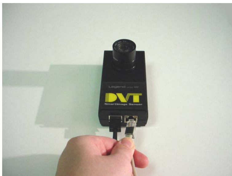
Slika 10. Spajanje Ethernet kabela s RJ-45 konektorima i DVT Vizijskog senzora.
