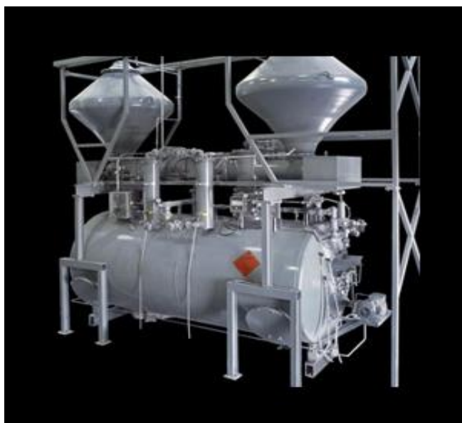
Slika 6. Razvijač acetilena s dva spremnika kalcijevog karbida – kontinuirani postupak [8]
