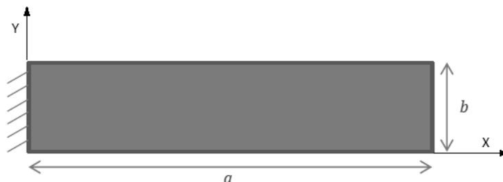
Slika 18. Pločasti element upet na jednom kraju
