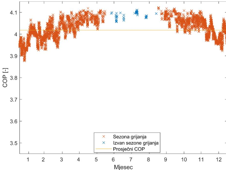
Slika 33: Faktori grijanja za svaki pojedini radni sat dizalice topline, frekventno regulirani rad
