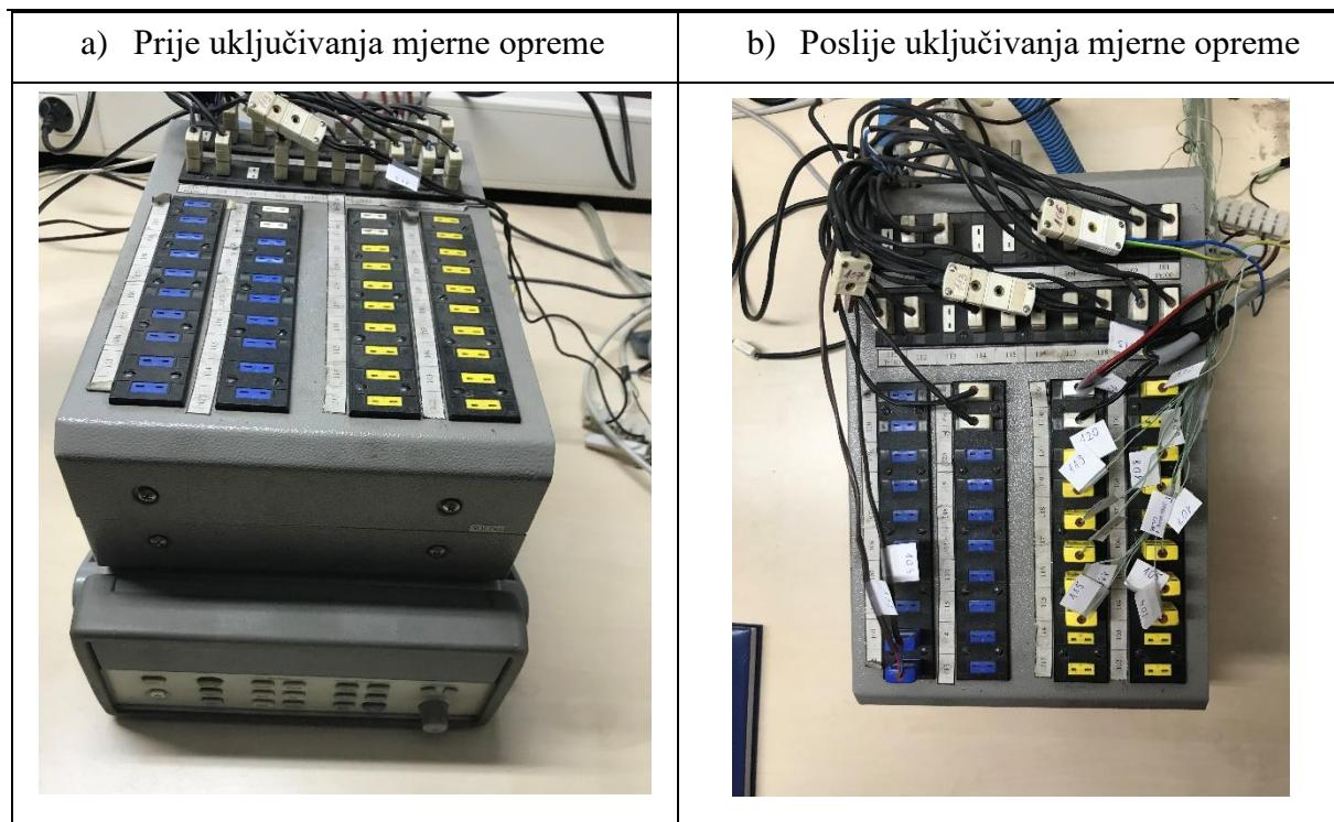
Slika 20: Akvizicijski sustav Agilent 34970 A prije i poslije spajanja mjerene opreme
