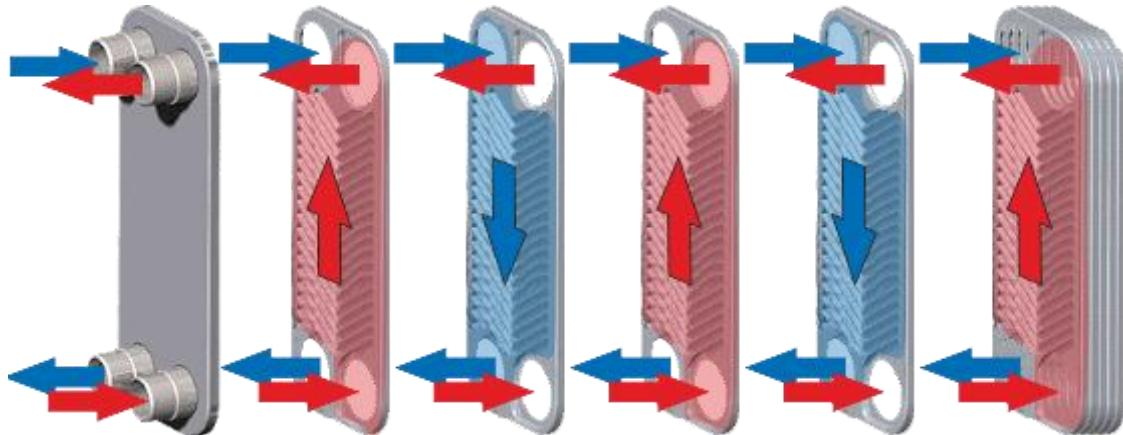
Slika 14. Kompaktni pločasti izmjenjivači topline, izvor [42]
