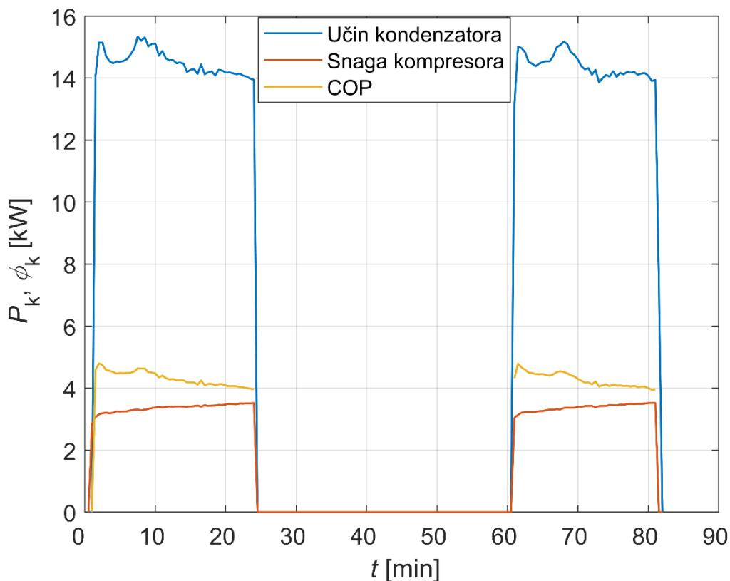
*Slika 23: Ovisnost snage kompresora i toplinskog učina kondenzatora u sustavu s „on-off“ regulacijom*
