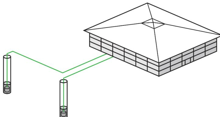
*Slika 5: Sekundarni krug otvorenog indirektnog sustava geotermalne dizalice topline, izvor [33]*
