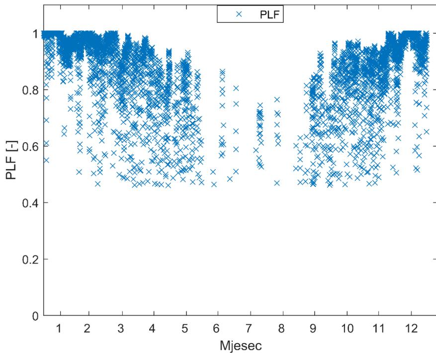
Slika 35: Satni faktori djelomičnog opterećenja za sustav s frekvenčijskom regulacijom
