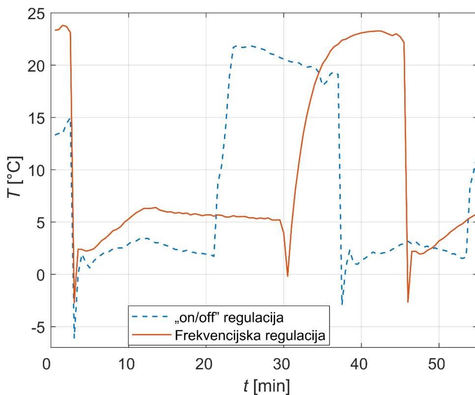
Slika 29: Usporedba temperatura isparavanja sustava s i bez frekvencijskog pretvarača,  $\Delta T = 3 \text{ } ^\circ\text{C}$
