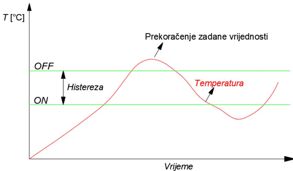
Slika 8: Dijagram rada uređaja u „on-off“ režimu, izvor [44]
