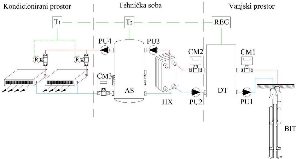
*Slika 13: Pojednostavljena shema sustava geotermalne dizalice topline, izvor [16]*
