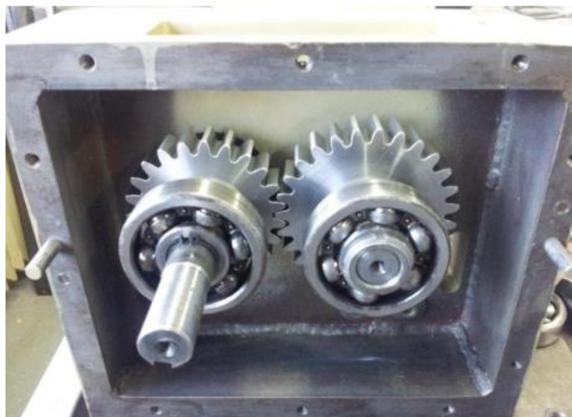
Slika 24. Montaža zupčanika kod pomoćnog prijenosnika [4]
