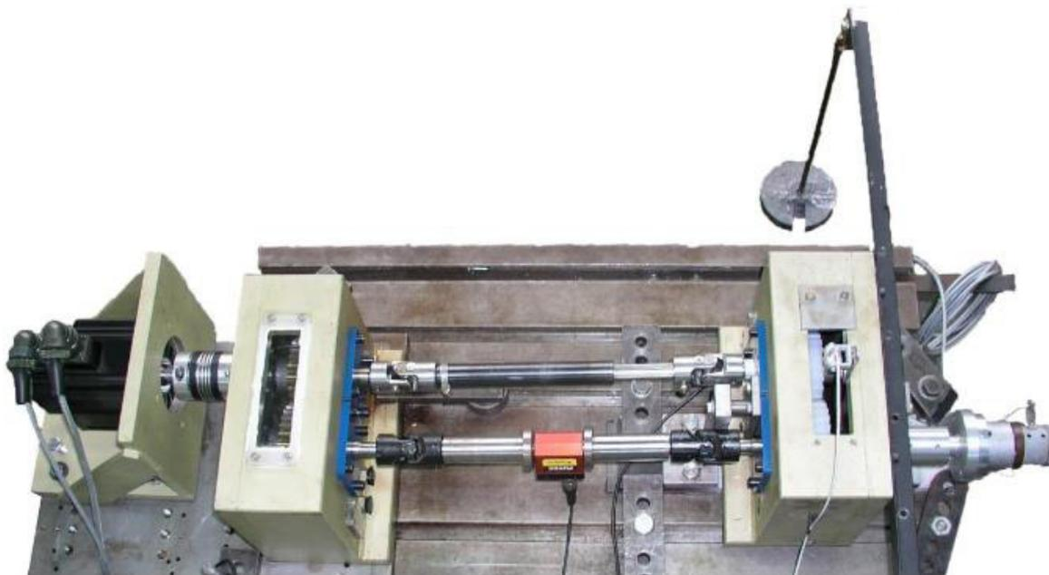
Slika 23. Realna izvedba uređaja za ispitivanje zupčanika (FSB) [4]
