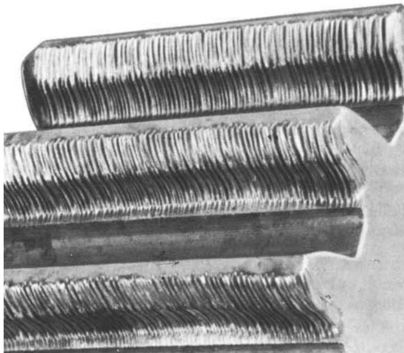
Slika 3. Pojava oštećenja čeličnog zupčanika nastalih habanjem [10]
