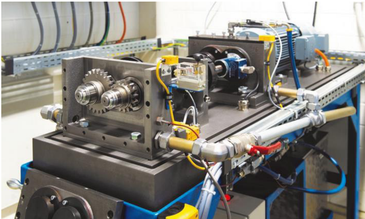
Slika 19. FZG uređaj za ispitivanje zupčanika [8]
