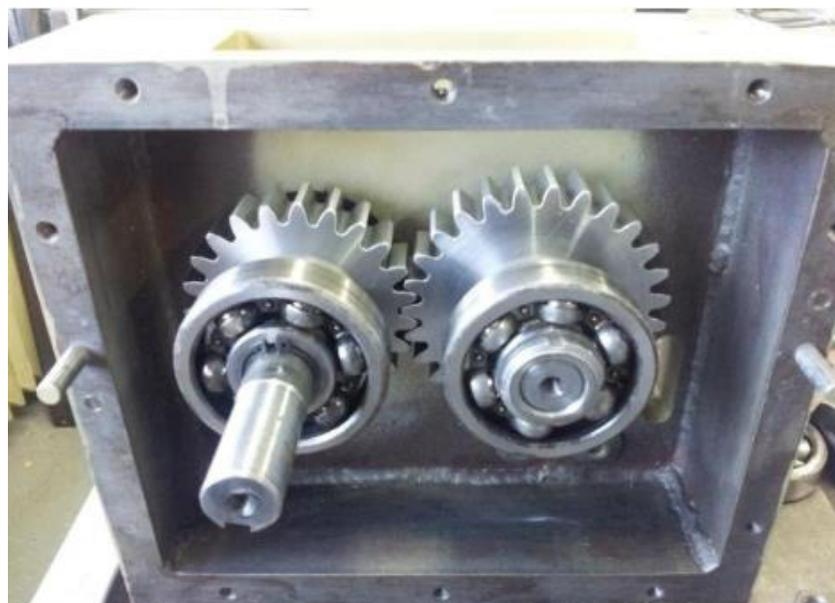
Slika 24. Montaža zupčanika kod pomoćnog prijenosnika [4]
