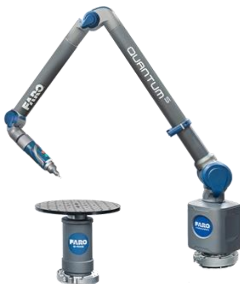
Slika 5. Prijenosni koordinatni uređaj FaroArm [12]
