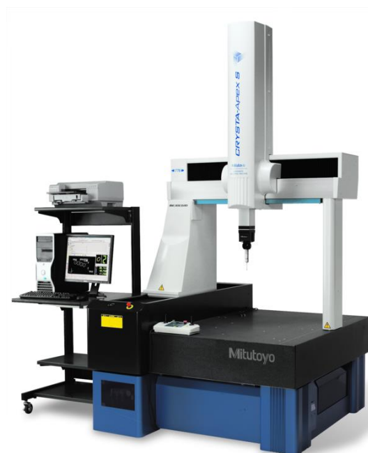
Slika 4. Koordinatni mjerni uređaj CRYSTA-Apex S 7106 [11]
