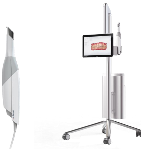
Slika 16. Intraoralni skener 3Shape Trios 3 [30]
