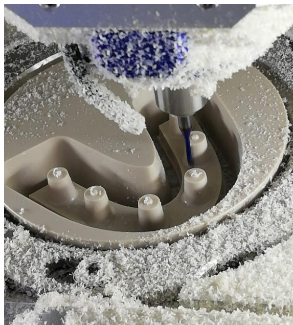
Slika 26. Glodanje detalja na modelu
