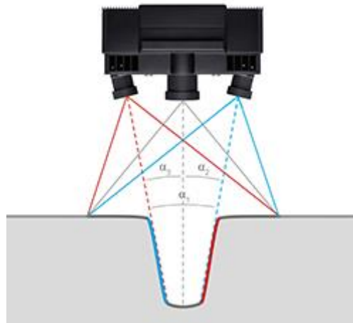
Slika 43. ATOS Triple Scan princip rada [17]
