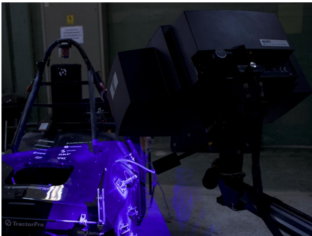
Slika 77. Proces skeniranja prihvata
