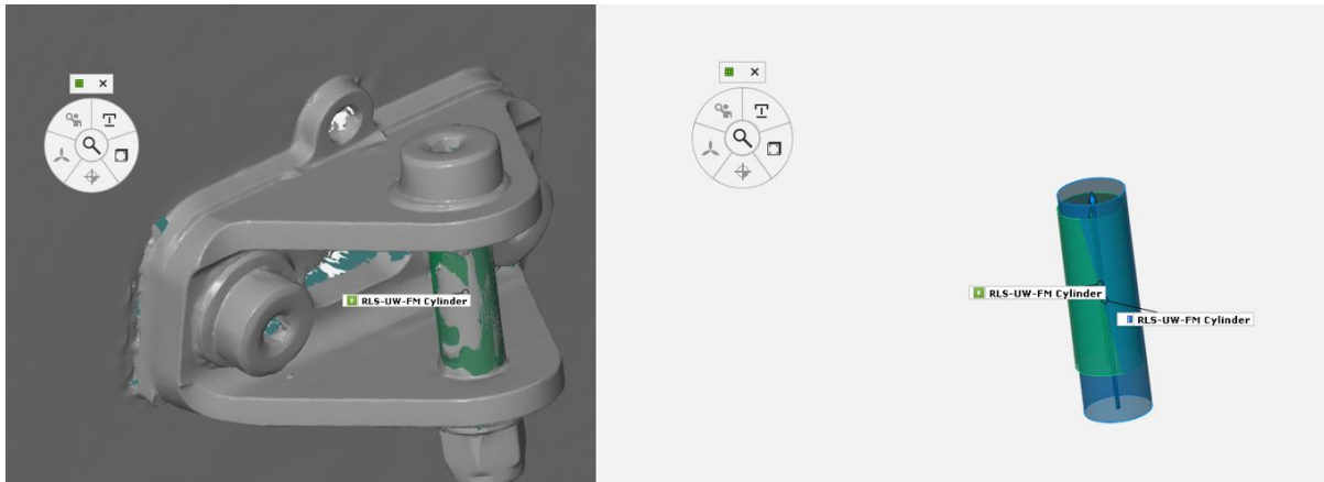
Slika 84. Prikaz cilindra na digitaliziranom modelu te usporedba s nominalnim cilindrom
