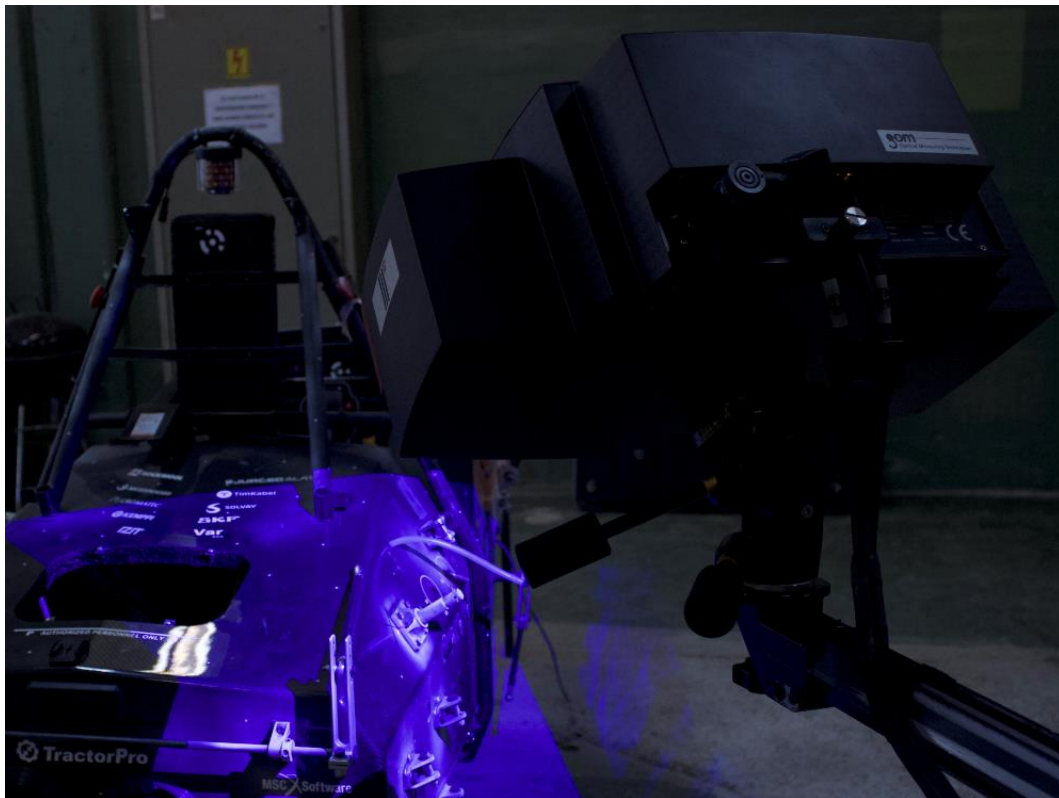
Slika 77. Proces skeniranja prihvata
