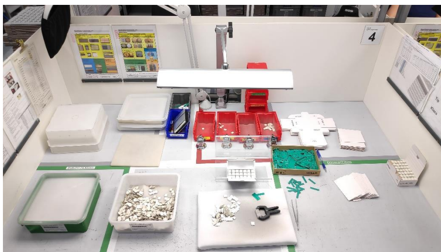
Slika 17. Radna stanica optičke kontrole
