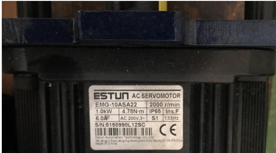
**Slika 16. Natpisna pločica elektromotora X i Y osi**
