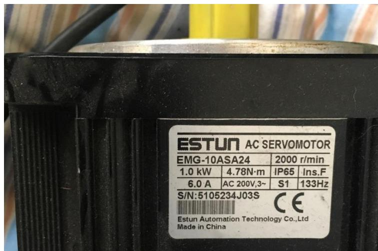
Slika 15. Natpisna pločica elektromotora Z-osi
