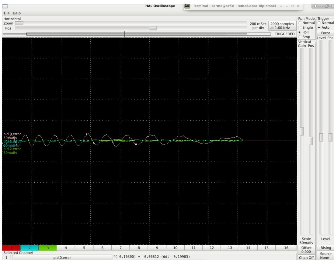
**Slika 21. Osciloskop – greška slijedenja: za X os (bijelo), Y os (plavo) i Z os (zeleno)**
