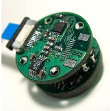
Slika 6.8 Beskontaktne EEG elektrode [111]
