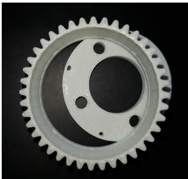
Slika 38. Raslojavanje flexspline-a od ABS-a
