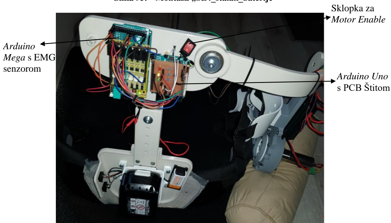
Slika 96. Montaža Arduino kontrolera „SL1_ploca_gore“
