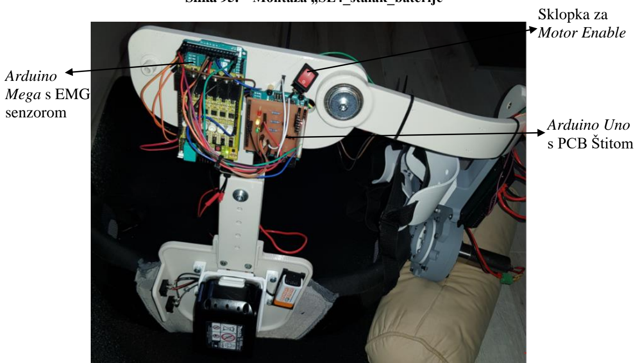
Slika 96. Montaža Arduino kontrolera „SL1_ploca_gore“
