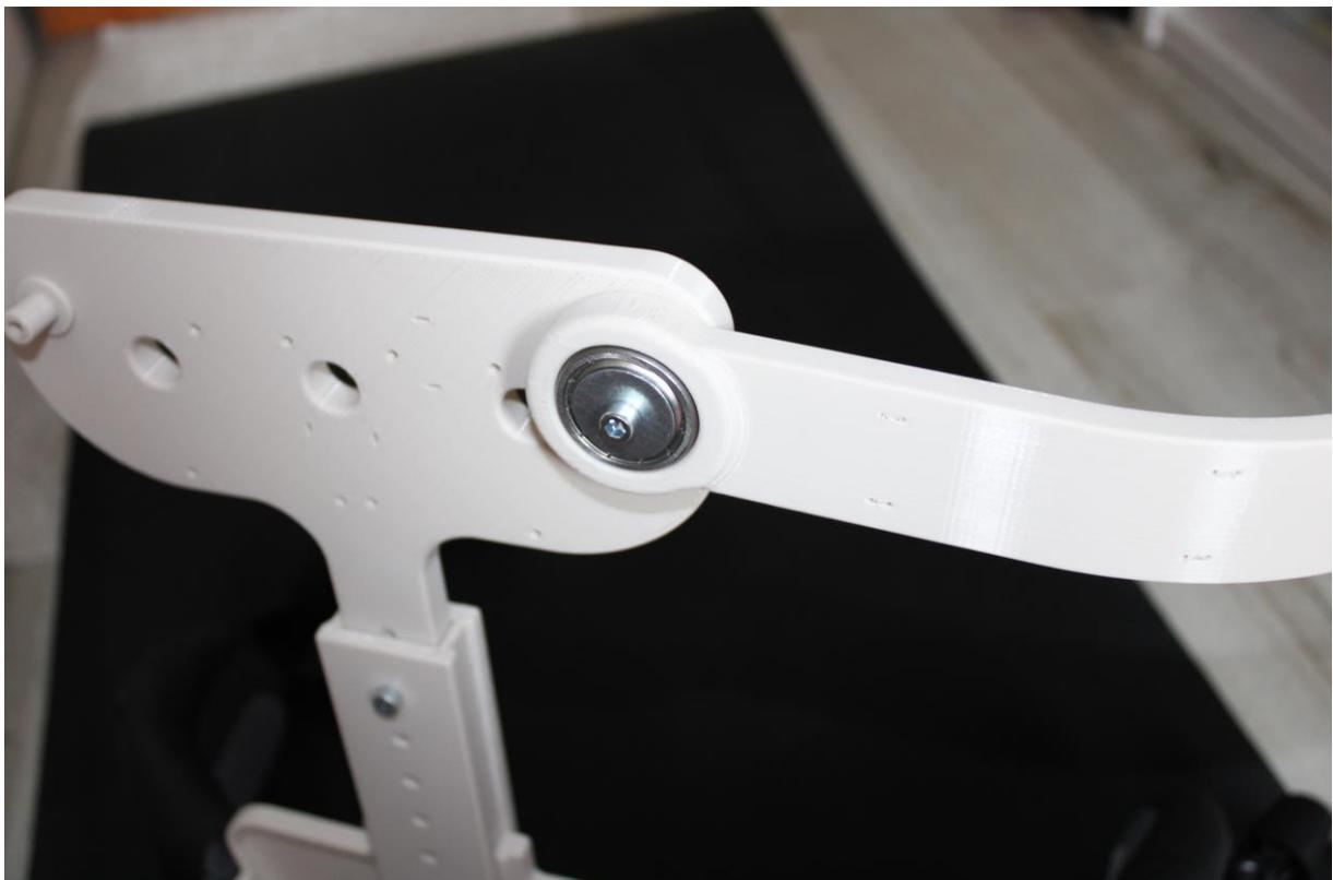
Slika 73. Pasivni zglob u spoju „Sklop\_leda“ sa „Sklop\_ruka\_leda“
