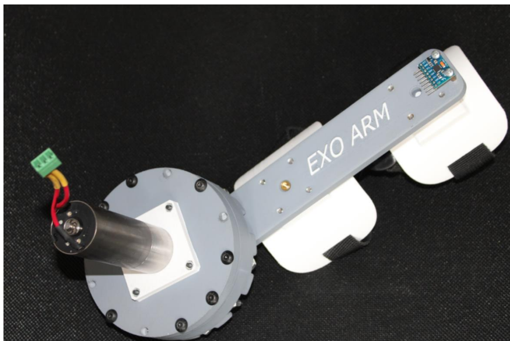
Slika 67. Sklop_ruka, „SR3_fiksacija_podlaktica“, „SR4_fiksacija_podlaktica_saka“, „SR6_podlaktica“, „Sklop_aktuator“
