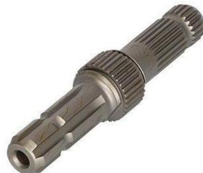
Slika 21. Izlazno radno vratilo traktora
