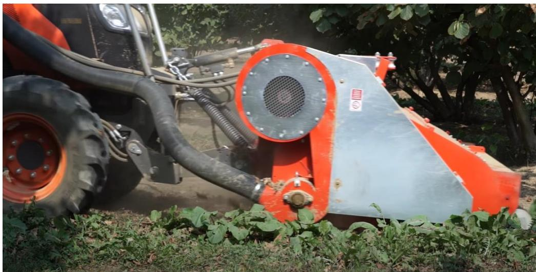
Slika 39. TR 200.2 - prikaz izlaznog crijeva za spremanje lješnjaka
