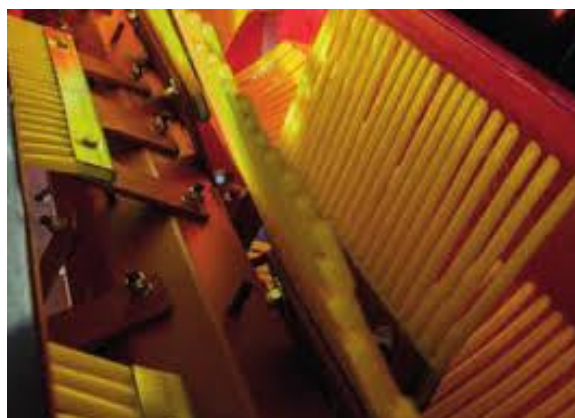
Slika 37. TR 200.2 - prikaz mehanizma sa četkicama za skupljanje plodova
