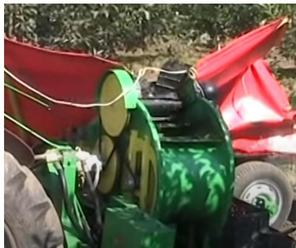
Slika 35. Model SP-05 - mehanizam za čišćenje ubranih plodova
