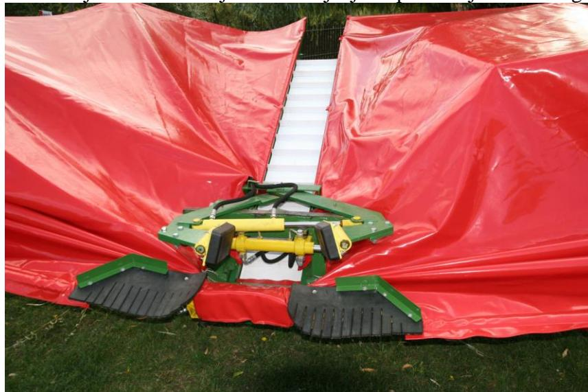
Slika 33. Model SP-05 - prikaz vibracijske glave, kišobrana i pokretnе trake
