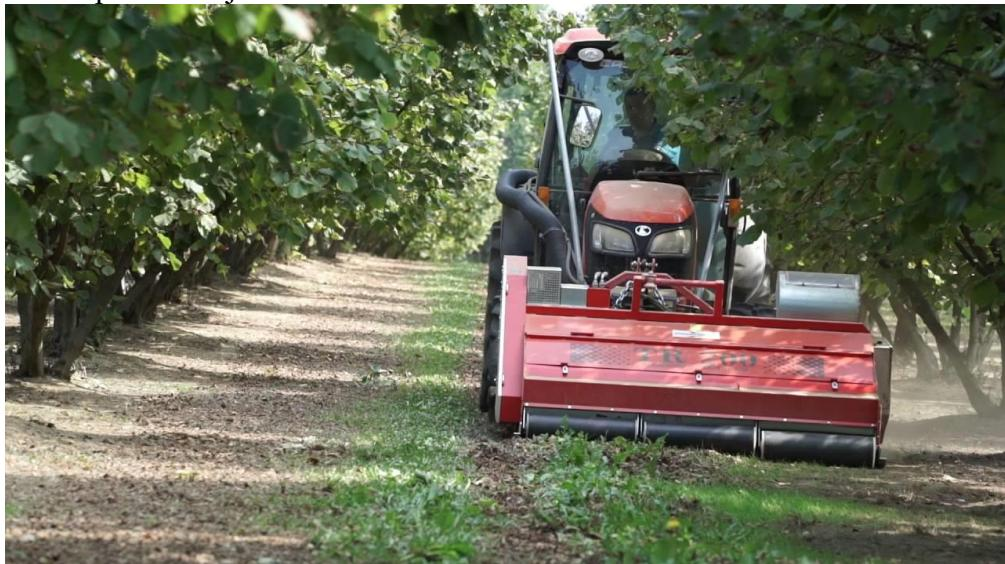
Slika 36. TR 200.2 - u radu uz primjenu bočnog pomaka
