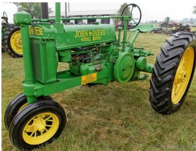
Slika 15. Traktor s benzinskim motorom i tri kotača [19]
