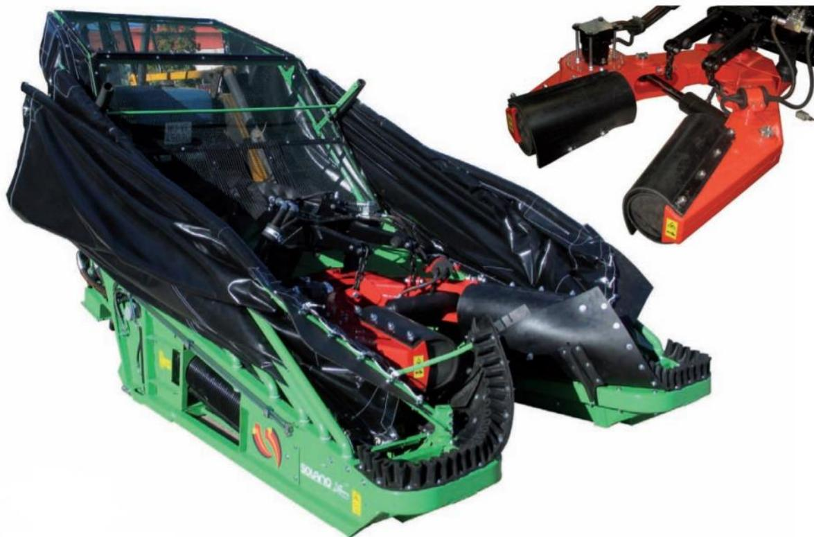
Slika 29. Serie 90 MIXT - prikaz uređaja i vibracijske glave
