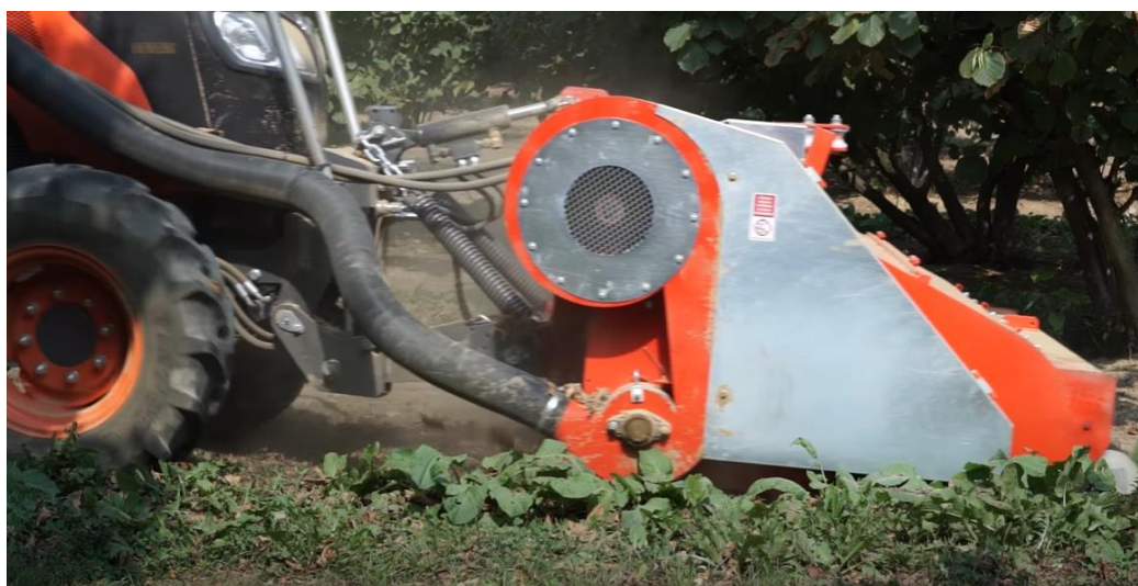
Slika 39. TR 200.2 - prikaz izlaznog crijeva za spremanje lješnjaka
