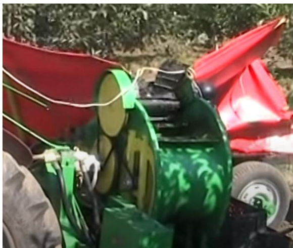
Slika 35. Model SP-05 - mehanizam za čišćenje ubranih plodova
