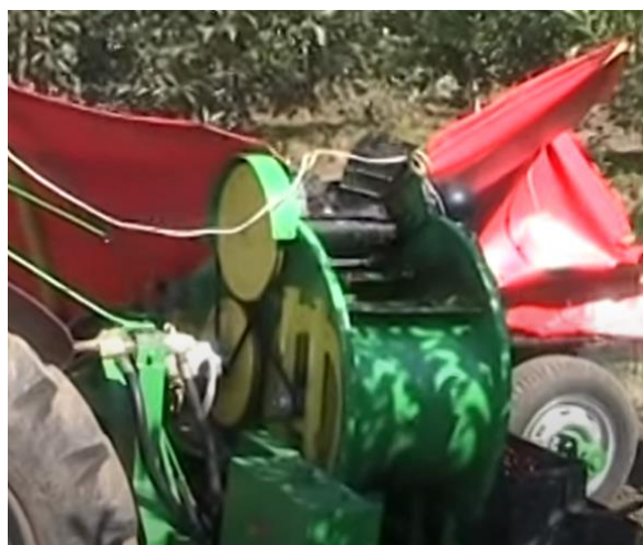
Slika 35. Model SP-05 - mehanizam za čišćenje ubranih plodova
