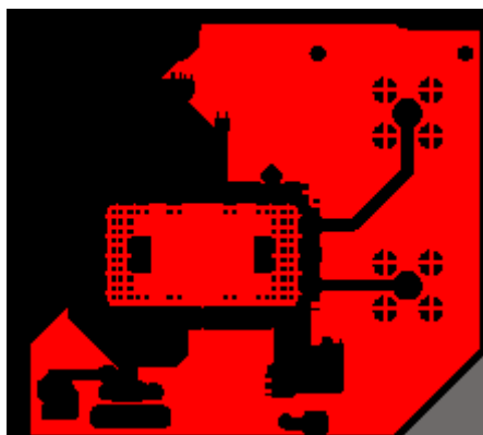
Slika 35 Polygon Pour oko dijelova modula za mobilnu mrežu na gornjem sloju
