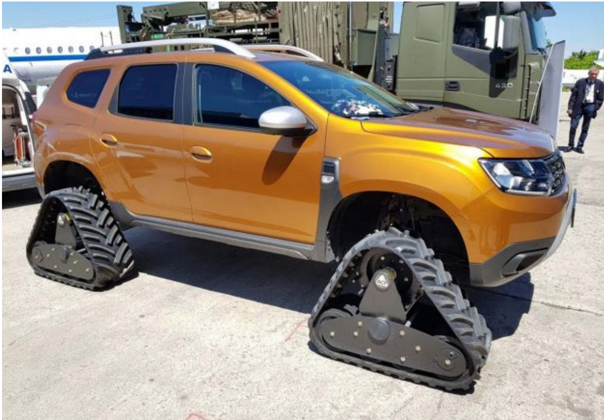
Slika 2. Kombinirani element kotač-gusjenica na automobilu
