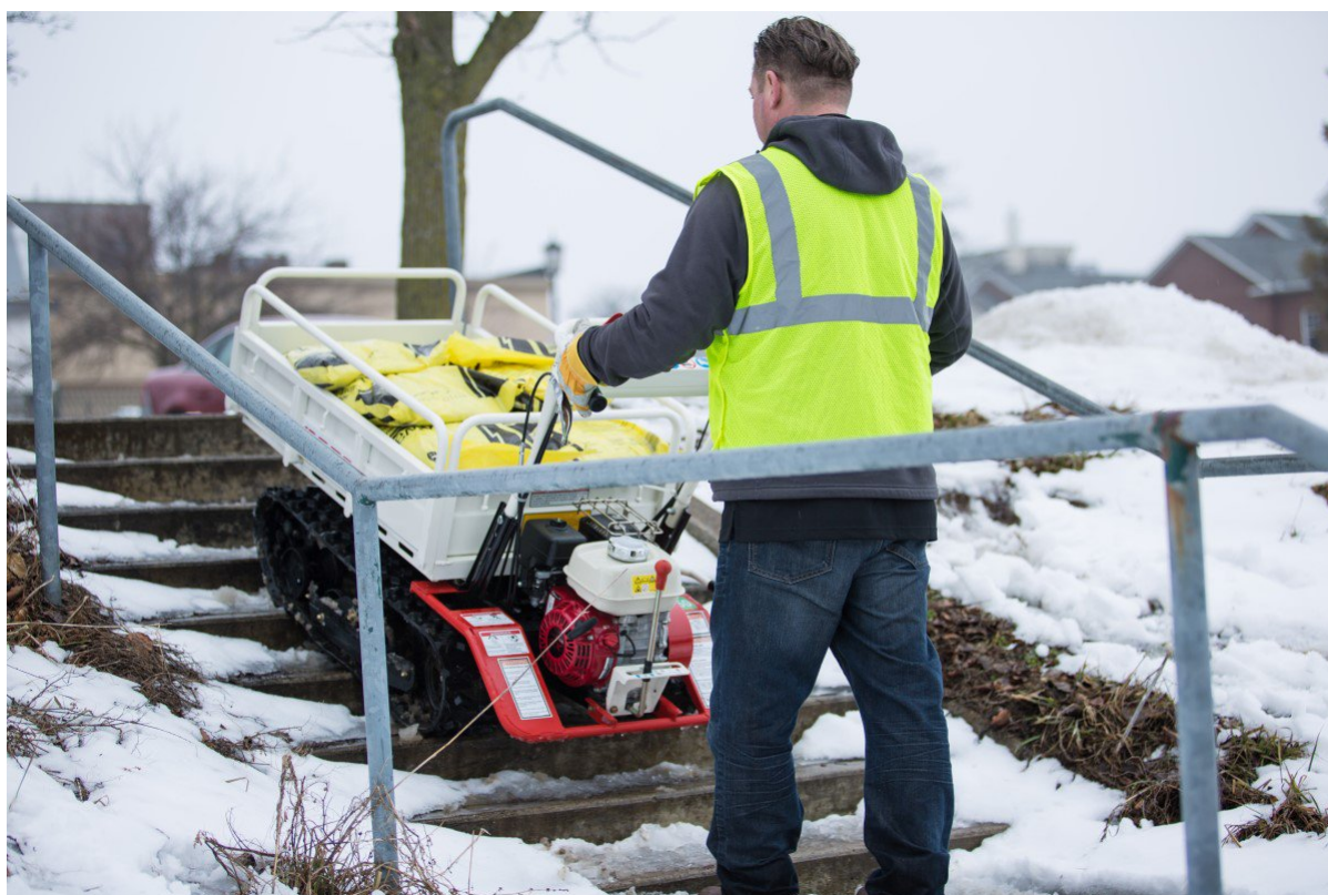
Slika 6. Motorizirana kolica s gusjenicama
