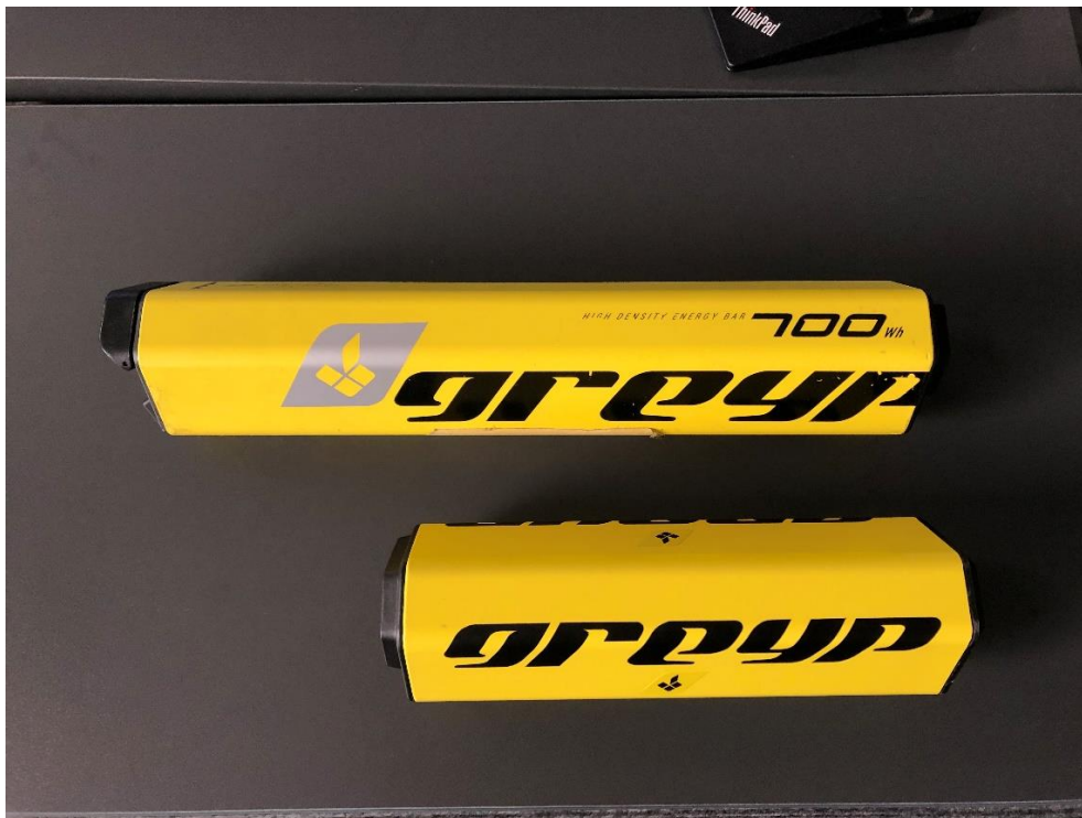
Slika 26. Usporedba baterije s bicikla (gornja baterija) s umanjenom verzijom baterije za mobilni robot (donja baterija)
