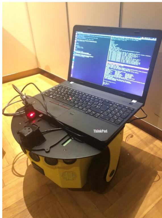
Slika 58. Ručno upravljanje mobilnim robotom
