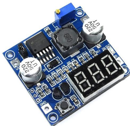
Slika 27. Modul za spuštanje napona LM2596-2 [18]
