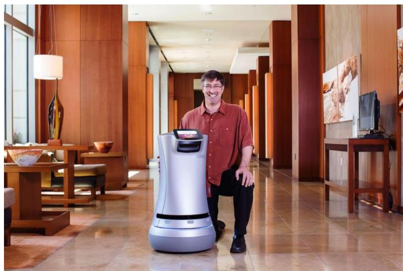
**Slika 7. Poslužni mobilni robot tvrtke Savioke Relay [7]**
