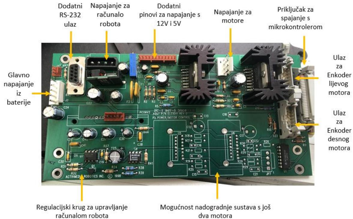
Slika 15. Pločica s napajanjem i driverima za motore
