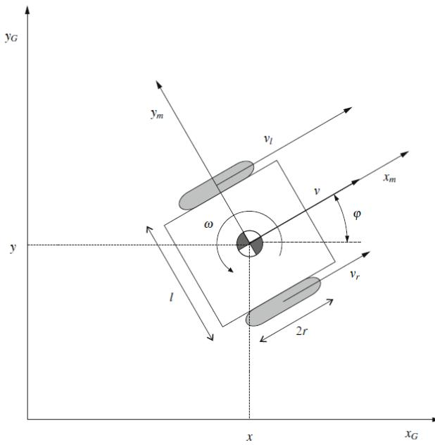
**Slika 5. Kinematski model mobilnog robota s diferencijalnim pogonom [5]**
