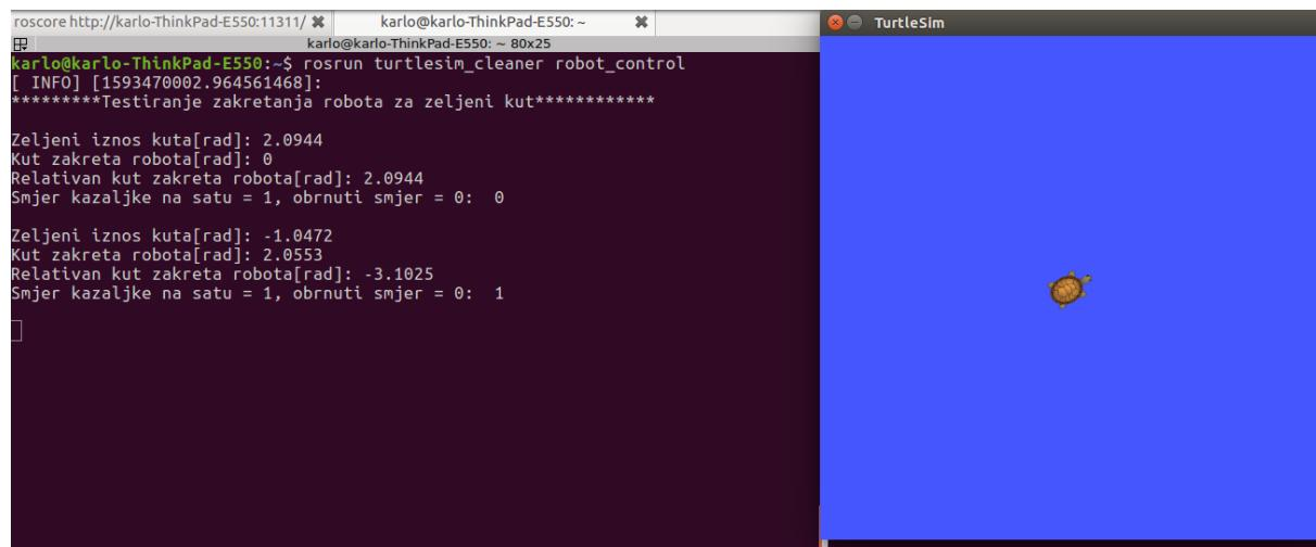
**Slika 54. Rotacija mobilnog robota za definirani kut**
