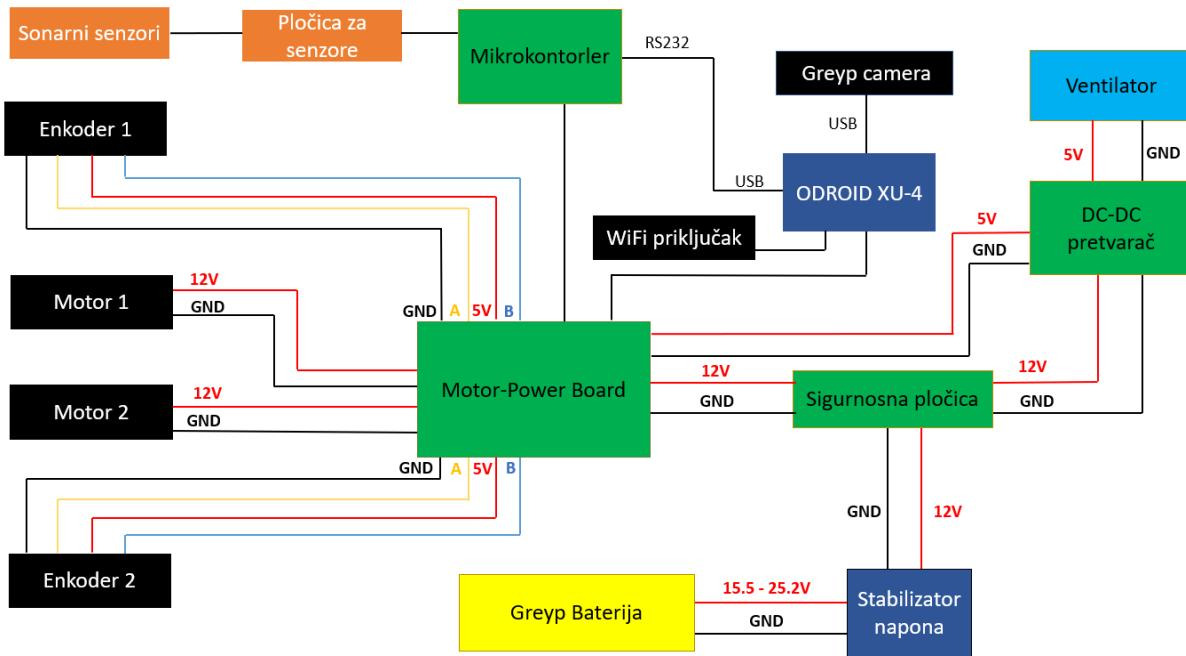
Slika 31. Električna shema spajanja komponenti mobilnog robota
