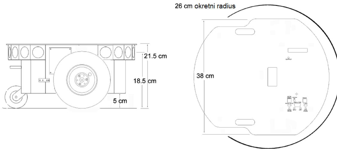
**Slika 12. Dimenzije mobilnog robota Pioneer 2-DX**
