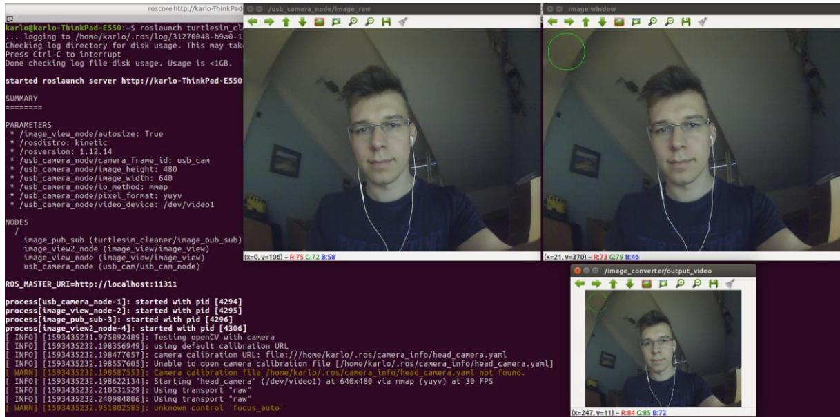
Slika 48. Testiranje funkcionalnosti integrirane kamere u ROS-u
