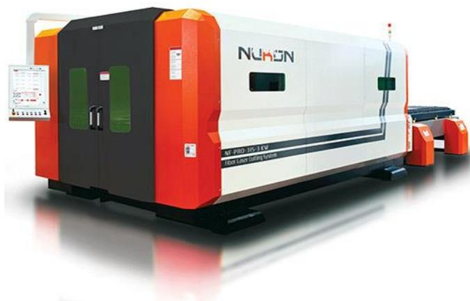
Slika 11. Laser za rezanje metala [15]
