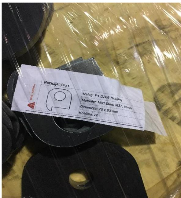
Slika 17. Označavanje pozicija izrezanih na laseru
